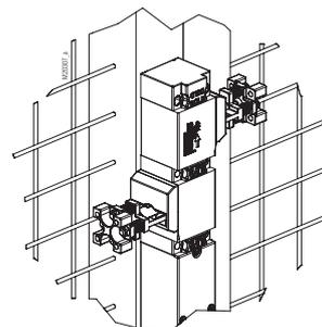
Les SAFEMASTER STS avec actionneurs doubles peuvent être utilisés pour surveiller 2 accès adjacents.
