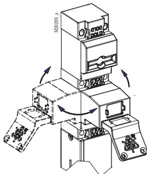
La conception modulaire et le principe de la clé à douille permettent un alignement variable des modules. Les touches et les actionneurs peuvent donc également être actionnés latéralement.
