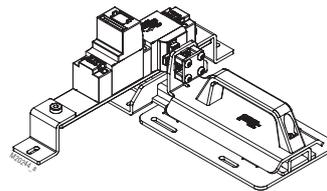
Le boulon CW se déplace sous l'unité montée, ce qui permet de fixer les portes battantes avec des butées à gauche et à droite. Il est conçu de telle manière que les forces de cisaillement ne peuvent pas agir directement sur l'unité STS. Il est particulièrement adapté aux applications, où des forces élevées peuvent agir sur les unités STS, par exemple dans les portes battantes doubles.
