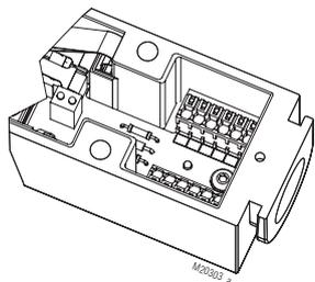
Le câblage peut être raccordé rapidement et facilement. Jusqu'à 1 mm<sup>2</sup> (avec embout, sans collerette).
