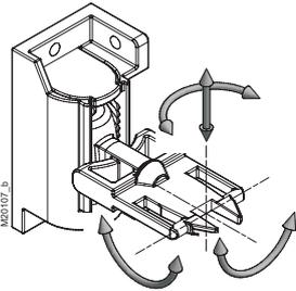
Der J-Betätiger ist in gestecktem Zustand über 4 Freiheitsgrade selbst justierend und behält seinen letzten Ausrichtungszustand bei. Er kann einen Versatz von bis zu 20 mm kompensieren.
