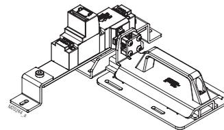
Der CW-Riegel fährt unter die montierte Einheit, wodurch der Schieber zur Absicherung von Drehtüren sowohl mit Links- als auch mit Rechtsanschlag geeignet ist. Er ist so aufgebaut, dass Scherkräfte nicht direkt auf die STS-Einheit einwirken können. Er eignet sich besonders für Anwendungen, bei denen große Kräfte auf die STS-Einheiten einwirken können, wie z. B. bei Doppelflügeltüren.
