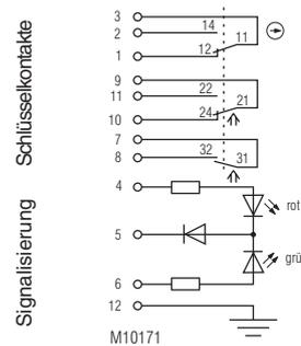
**Bild 2:** Verriegelung im deaktivierten Zustand: Schlüssel gesteckt, Betätiger entnommen, Tür geöffnet
