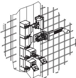
Pour les applications catégorie 4, avec le niveau de performance e, les unités SAFEMASTER STS peuvent également être équipées de 2 actionneurs.
