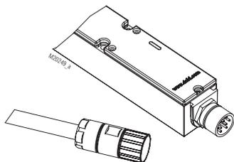
Les modules de commande SAFEMASTER STS peuvent également être équipés de connecteurs.
