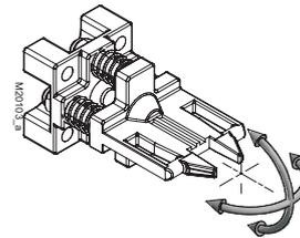
Der C-Betätiger mit einstellbarem Betätigerwinkel ist federnd gelagert. Er kehrt nach einer Belastung in seinen eingestellten Zustand zurück.
