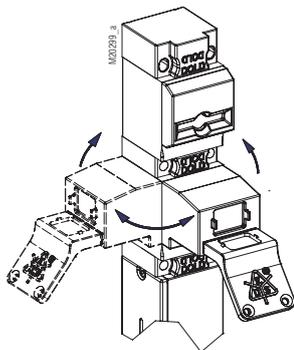
Der modulare Aufbau und das Steckschlüsselprinzip erlauben eine variable Ausrichtung der Module. Schlüssel und Betätiger lassen sich somit auch seitlich bedienen.
